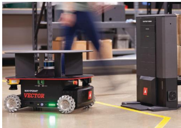
Pilt 4.19. Autonoomne mobiilne robot Waypoint „Vector“. (mmh.com)
