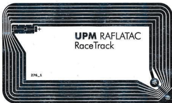
Pilt 14.11. Passiivne raadiomärk UPM Raflatac. (Autori foto)
