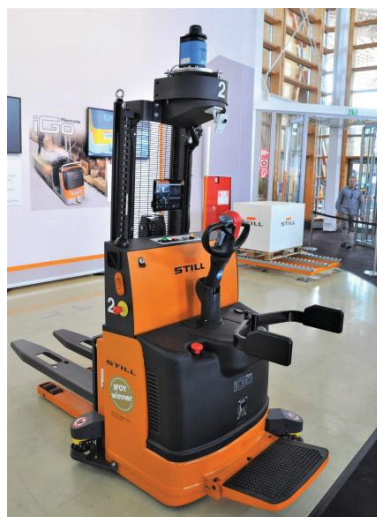
Pilt 5.43. Still poolautomaatne Pilt. 5.44. Still poolautomaatne tugiratastõstuk. (Autori foto)
