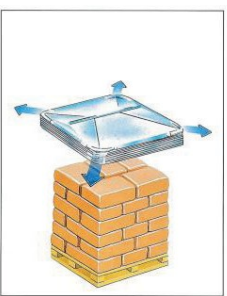
Pildid 11.27. Kaubaaluse pakendamine termokahaneva pakkekilega. (Beumer tootekataloog)
