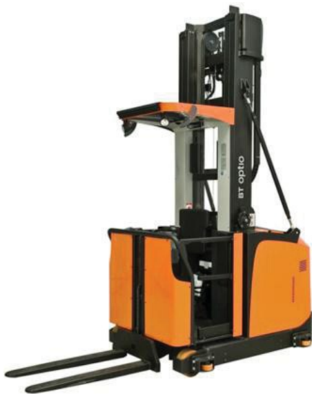
Pilt 5.25. Kõrgkomplekteerimistõstuk Toyota-BT Optio 1,0 t 11,0 m. ( toyota-forklifts.se )
